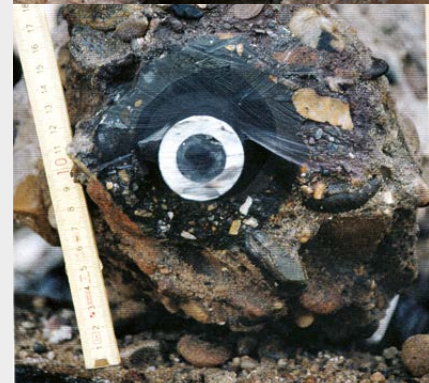
Abbildung versuchsweise ausgegrabener Verpresskörper im Querschnitt. Gut zu erkennen ist die Verzahnung von Stahltragglied, Zementstein-Überdeckung, Filterkuchen und Boden. Das eingeschlossene Stahltragglied mit Kopplungsmuffe ist dauerhaft korrosionsschutz.
