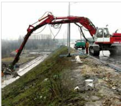
**Slitta montata su macchina cingolata ad azionamento idraulico**
