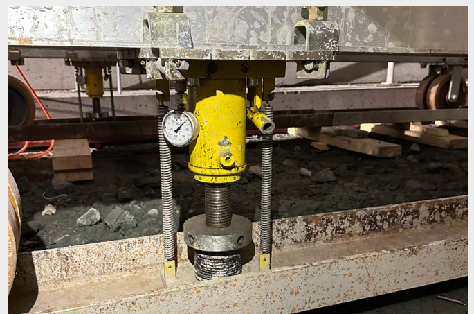
Hydraulikzylinder zum Abheben der Räder vom Boden.
