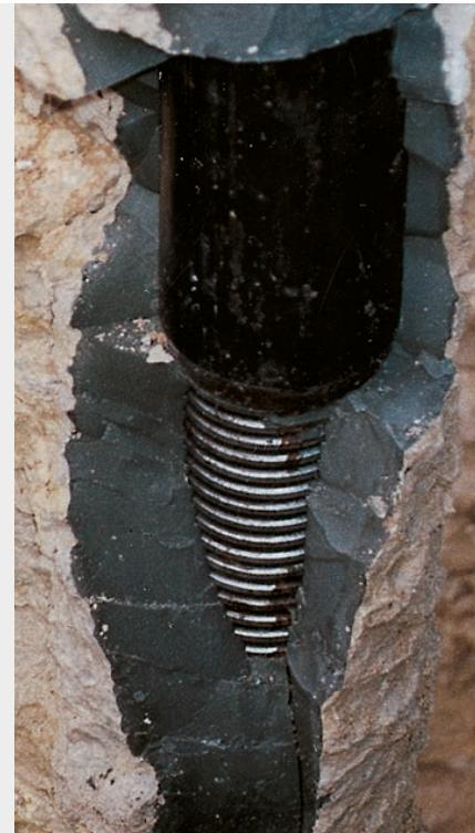
**Abbildung** versuchswise ausgegrabener Verpresskörper im Querschnitt. Gut zu erkennen ist die Verzahnung von Stahltragglied, Zementstein-Überdeckung, Filterkuchen und Boden. Das eingeschlossene Stahltragglied mit Kopplungsmuffe ist dauerhaft korrosionsschützt.
